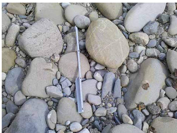
Bild 30 Die Kiesbank weist eine sehr grobe Zusammensetzung auf, die Steine und Blöcke weisen einen maximalen Durchmesser von 40cm auf (7.4.2014).
