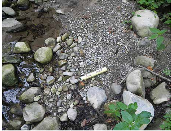
Bild 135 Feinkiesablagerungen auf grober Sohle bachaufwärts der Fassung (26.6.2014).
